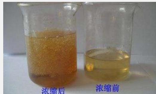
(2) 乙醇沉淀果胶：向所得浓缩液中边搅拌边加入等体积的70%-100%的乙醇溶液，得淡黄色沉淀，静置2h，用400目滤布过滤分离，所得沉淀物用相同浓度的乙醇溶液洗涤两次，去除色素和杂质；乙醇做回收处理，沉淀物在70℃烘干，粉碎机粉碎，即得果胶干燥品。
